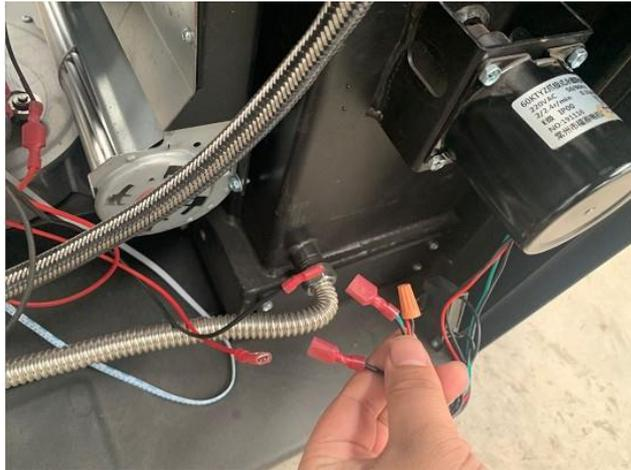
5. Nehmen Sie die Sensorkabel von der Steuerplatine und schneiden Sie sie ab.
