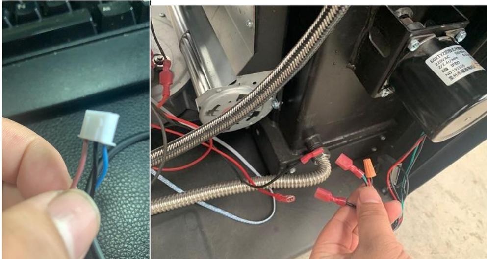
2. Tauschen Sie den Sensor oder verwenden Sie den Ofen ohne Aschenreinigungssystem und reinigen Sie manuell mit dem Aschestaubsauger !
